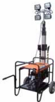
MOD. TA/B 5500/4 X 500 W - MOBILE TORRE H MT. 5,5 CON GRUPPO ELETTROGENO BENZINA MOD. BI8C1M3/1 - 7,5 KVA
