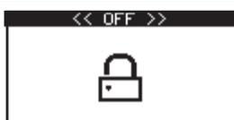
Immagine visualizzata quando si passa in off. In OFF il motore non può essere avviato in alcun modo e se è in moto viene arrestato senza eseguire il raffreddamento motore.
