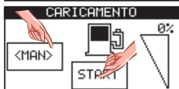
Caricamento manuale: premendo il tasto START visualizzato nel display si attiva l'uscita del caricamento, lasciando il tasto l'uscita si disattiva.
