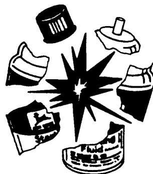
Il fluido di avviamento è infiammabile
