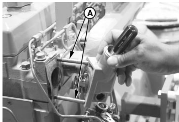
Installazione del coperchio dei termostati
